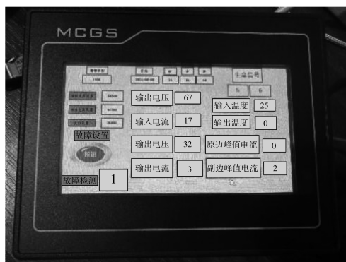
图14 S_1 开路故障后的故障检测
