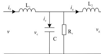
图4 电容并联电阻等效电路
