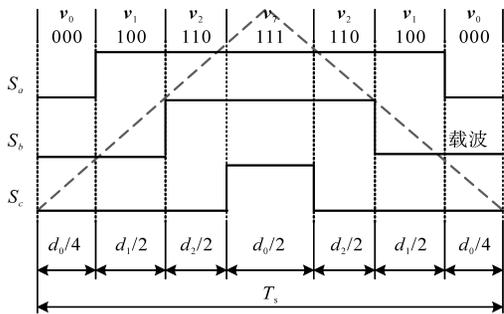
图8 七段对称式脉宽调制脉冲生成
