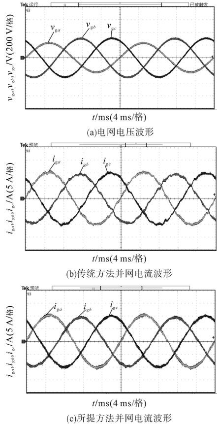
图17 一相电网电压降落的试验结果
