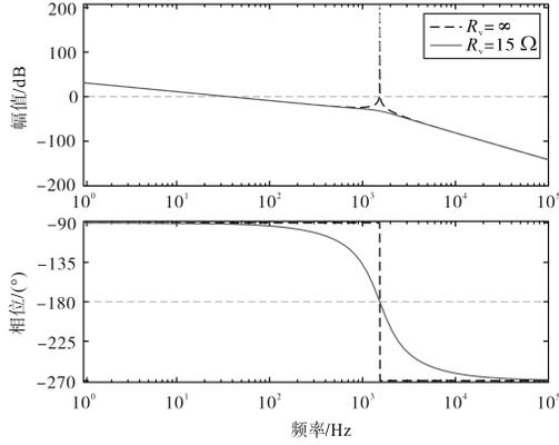
图5 电容并联电阻有源阻尼伯德图
