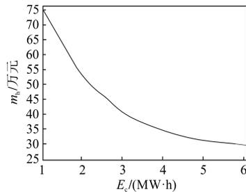
图5 系统储能配置容量和考核成本的关系
