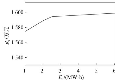
图4 系统储能配置容量和收益的关系
