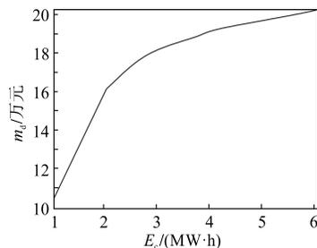
图6 系统储能配置容量和电池损耗成本的关系
