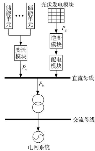
图1 光储电站的基本模型结构图
