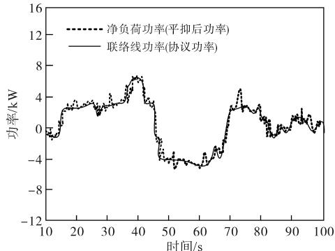
图 5 混合储能系统的平抑效果
