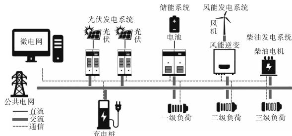
图1 某混合储能微电网结构
