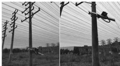
图13 机器人爬杆高度测试
