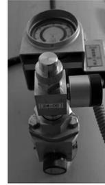
图16 新型抗干扰远传式SF<sub>6</sub>密度继电器现场样机
