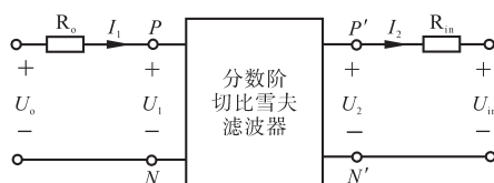
图11 硬件抗干扰等效电路图
