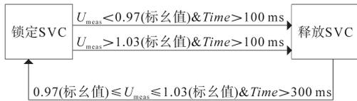
图3 电压死区控制原理图
