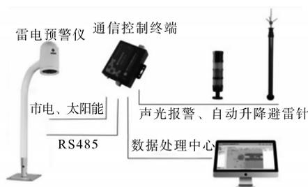
图1 雷电预警系统图
