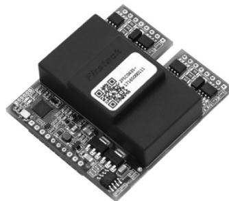
图2 2FSC0435 驱动核外形结构
