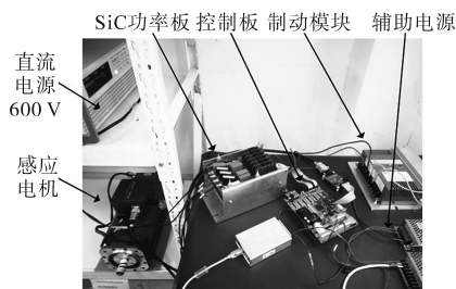
图11 SiC驱动器物理实验平台
