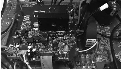
图9 非隔离LLC谐振变换器样机
