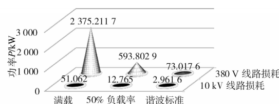
图6 不同负载率下的线路谐波损耗占比
