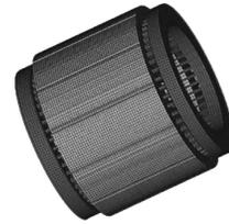
图8 定子铁心和绕组结构有限元模型
