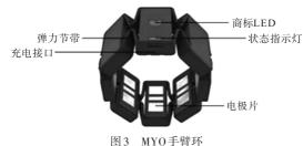
图 3 MYO 于實外 Fig. 3 MYO arm ring
