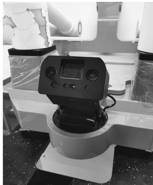
图4 机载设备在配网带电作业机器人的部署图
