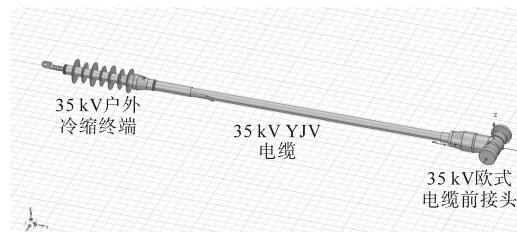
图1 35 kV 欧式电缆接头仿真模型图
