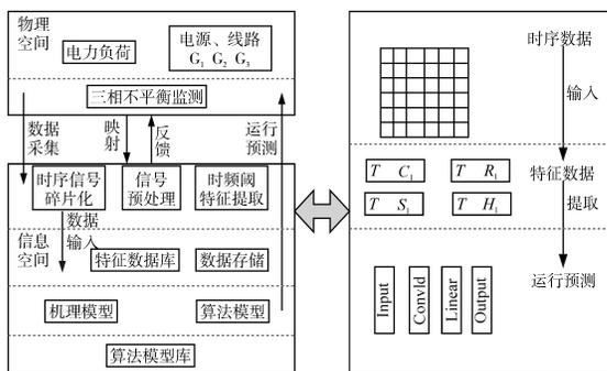
图1 微电网可迁移数字孪生模型
