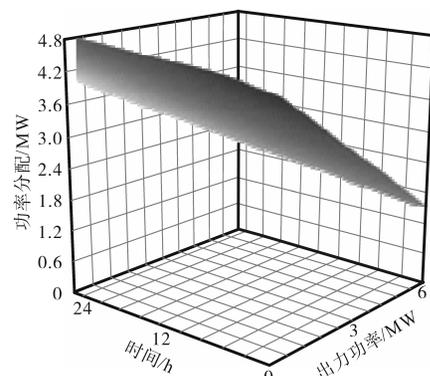
图4 超级电容器的功率分配结果
