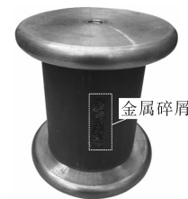
图2 绝缘子表面金属污秽实物图
