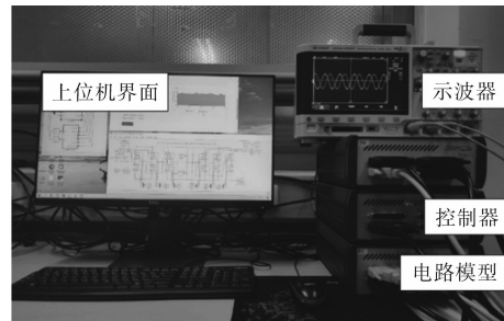
图7 RT-BOX硬件在环测试平台
