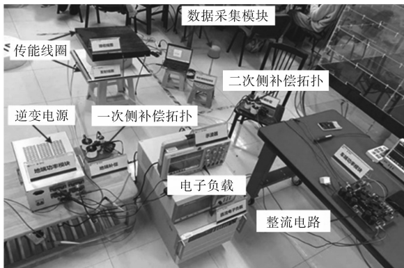
图7 LCC-S型WPT系统实验平台
