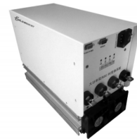
图5 实验用双向DC-DC变换器
