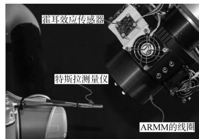
图6 磁感应强度的测量配置
