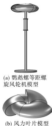
图1 新型鹦鹉螺等角螺旋线型垂直轴风力机结构
