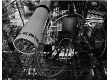
图2 双脉冲测试实验电路
