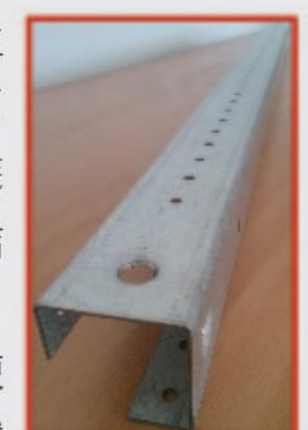
7.2 相对于采用专业成型机加工的型材来说，开口方型材结构简单，折弯便捷，可方便的采用普通折弯机加工即可，按量加工，减少库存量。侧板的采用则大大提高了结构的机械强度，安装布置灵活方便，使整机的综合指标大大提高。为加强通风和散热，在柜体的下部、后上部及顶部均有散热孔，使柜体在运行中形成自然通风道，有较好的散热性能。柜体顶端四角均安装有吊环，便于起吊装运。
